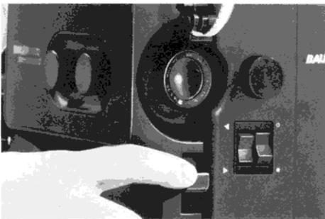
Die Bildscharfe stellen Sie mit Drehknopf 10 ein. Falls die Trennlinie zwischen zwei Filmbildern (»Bildstrich«) bei der Projektion sichtbar ist, verstellen Sie ihn mit Drehknopf 9.
