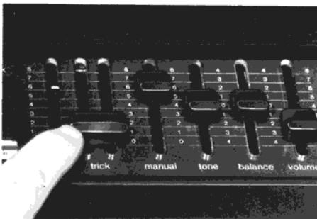
Die gewünschte Abschwächung der ersten Tonaufnahme (»trick«-Reglerstellung) ermitteln Sie bei einer Probevertongung.
