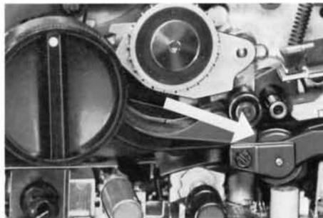
In den Betriebsschalterstellungen »3« ☉ (Vorwärtsprojektion mit Sparlicht) bzw. Stufe »4« ☉ (Vorwärtsprojektion mit Volllicht) ist die Gummi-Andruckrolle an die Tonwelle angedrückt. Dies kann bei längerem Stillstand des Projektors die Andruckrolle deformieren (z. B. als »jaulen« hörbar).
