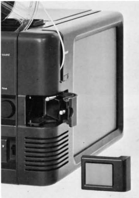
Den Monitor-Bildschirm **24** entnehmen Sie dem Fach an der Rückseite des Projektors.
