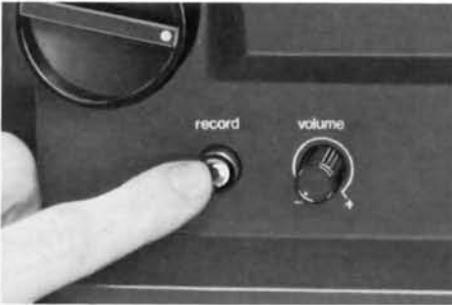
In den Betriebsschalterstellungen »Einfädeln« und »Rückwärtslauf« rastet die Aufnahmetaste 9 nicht ein.
