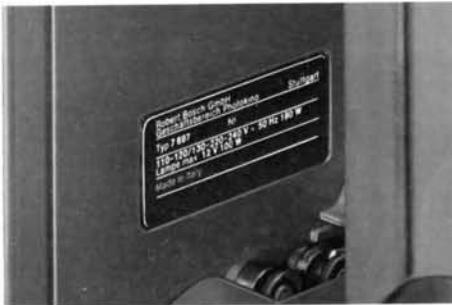
Die Netzanschlußwerte – Netzfrequenz, Wechselspannung – Ihres Projektors finden Sie auf dem Typenschild an der Seite des Gerätes (unter der Achse für die Aufwickelspule).
