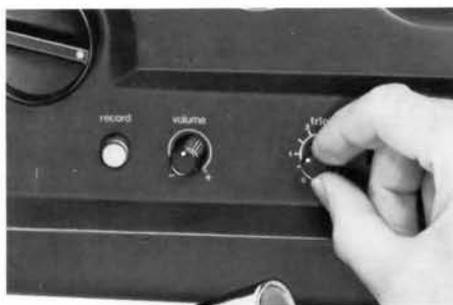
Am Aufnahmeende drehen Sie den Trickregler zurück auf »0« an den linken Anschlag.
