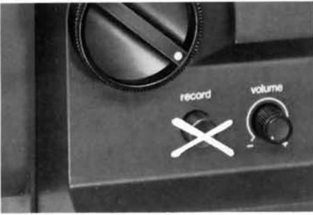
**Achtung:** Während der Vorführung darf **keinesfalls** die rote Aufnahmetaste 9 (»record«) gedrückt werden, da sonst die Tonaufzeichnung gelöscht würde.
