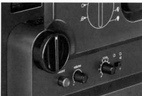
Wenn Sie den Betriebsschalter 1 aus der Stellung »A« nach rechts (Filmeinfädellstellung (→)) oder nach links (Stellung »●«) drehen, springt die Aufnahme-taste 9 wieder heraus.
