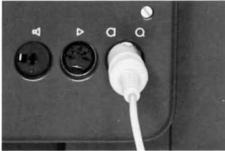
Den Plattenspieler oder das Tonbandgerät schließen Sie an der Buchse **28** an.
