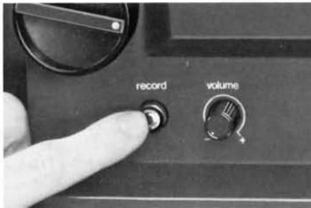
Jetzt drehen Sie den Betriebsschalter **1** nach rechts auf Stufe 3 (Projektion mit Lampensparschaltung) und drücken die Aufnahmetaste **9** (»record«).
