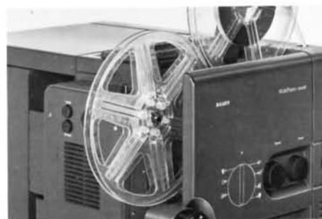
Auf die Aufwickel-Spulenachse 23 setzen Sie eine Leerspule.
