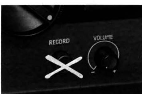
Achtung! Während der Vorführung darf **keinesfalls** die Aufnahmetaste 9 (»record«) gedrückt werden, da sonst die Tonaufzeichnung gelöscht würde.
