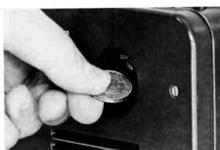
Bei abweichenden Netzspannungen können Sie den Spannungswähler 21 mit Hilfe einer Münze umschalten.
