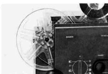
Der Film wird jetzt von der Einfädelautomatik durch den gesamten Filmweg bis in die Aufwickelspule geführt.
