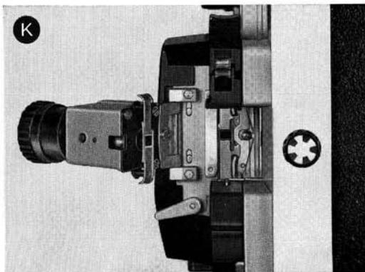
**Pflege und Reinigung:** Den Objektivträger (Abb. K) zur Seite klappen; jetzt können Filmfenster und Andruckplatte mit einem weichen Pinsel gereinigt werden.
