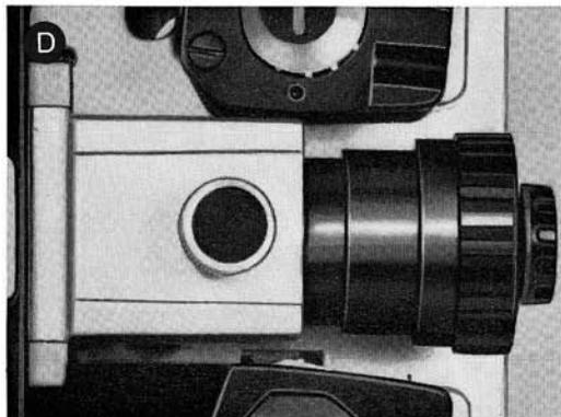
**Lampe voll einschalten:** Die Drucktaste für Lampe (16) drücken, jetzt leuchtet die Halogenlampe mit voller Leuchtkraft.
