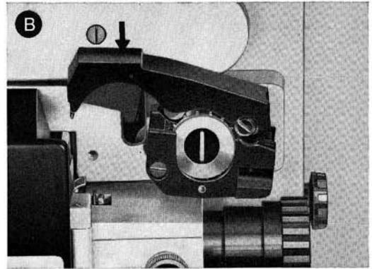
**Vollautomatische Filmeinfädung:** Die obere Filmführung (4) bis zum Anschlag niederdrücken (Abb. B), sie rastet ein. Den Film-anfang in die Öffnung der Filmführung stecken (Abb. C) und die Drucktaste für Vorwärts-Projektion (18) drücken. Der Film wird jetzt transportiert, die Halogen-Lampe leuchtet zur Vorwärmung mit Spar-schaltung. Wenn der Film-anfang durch die untere Filmführung (9) läuft, springen beide Filmführungen (4, 9) automatisch in Normalstellung für Filmtransport.
