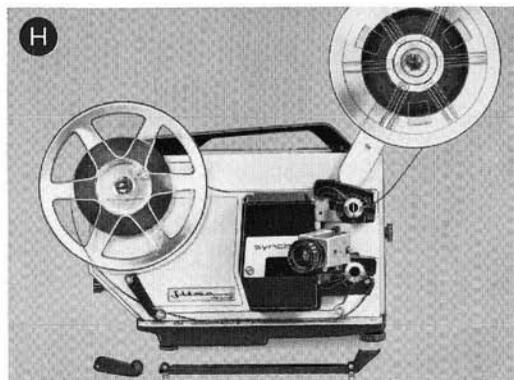
**Filmwechsel während der Projektion:** Den Projektor ausschalten (19), die Halteschrauben des Filmkanals (14) lösen, Filmkanal (15) und Leitschiene (12) abnehmen, dann den Objektivträger zur Seite klappen (Abb. H). Der Film wird aus der oberen und unteren Filmführung (4, 9) herausgefädelt; jetzt können beide Filmspulen zusammen mit dem Film abgenommen bzw. der Film zurückgespult werden.
