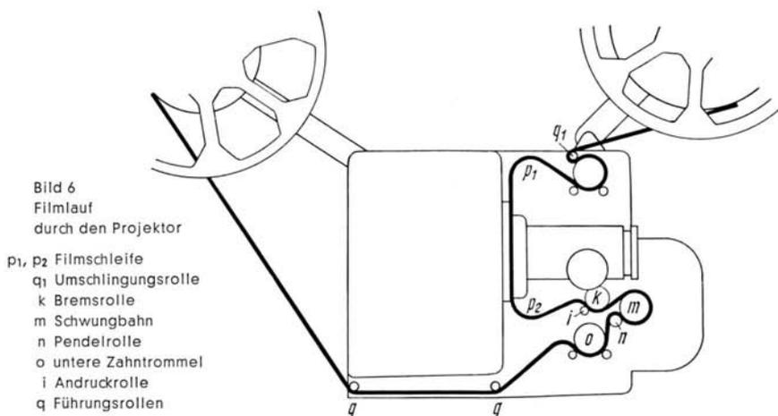
6. Achse I der Andruckrolle i (Bild 6 und 7) nach unten abschwanken und in axialer Richtung einrasten.
