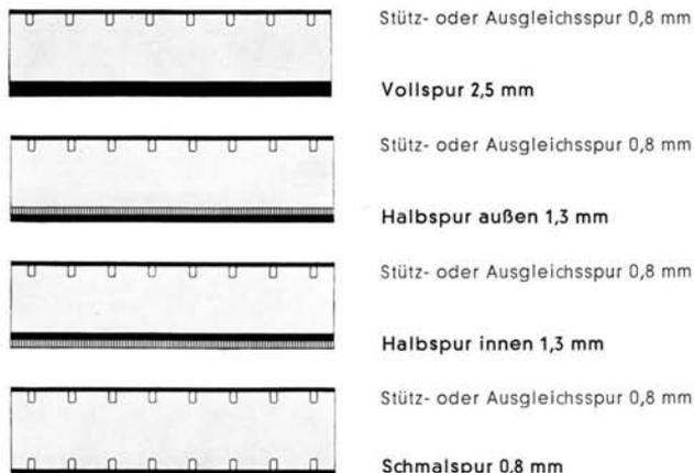
Um für die verschiedenen Magnettonspuren beste Tonqualität zu erzielen, wurden getrennte Magnetköpfe vorgesehen, da beim Abtasten einer 0,8 mm Schmalspur mit dem Magnetkopf für 2,5 mm Vollspur in den Magnetkopfbügel eine Stufe eingeschliffen wird. Diese hat eine Qualitätsminderung beim späteren Abtasten der 2,5 mm Vollspur zur Folge.
