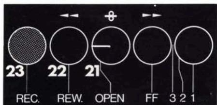
**Achtung, wenn der Projektor nicht in Betrieb ist, sollte der Tonband- (TB) Schalter (21) in waagrechter Stellung und der Zentralschalter (11) auf Position O stehen. Ansonsten drückt sich die Antriebswelle in die Gummi-Rolle und es können dadurch Gleichlaufschwankungen auftreten.**
