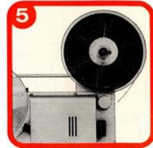
Filmspule auf vorderen Spulenarm so setzen, daß die kleine Nase an der Achse in den Spulenschlitz eingreift. Filmperforation weist zum Benutzer. Projektor ausschalten: Taste
