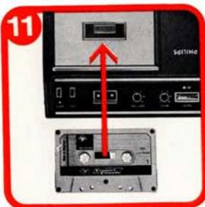
Liveton-Cassette (Seite 1 nach oben) in Recorder einsetzen.
