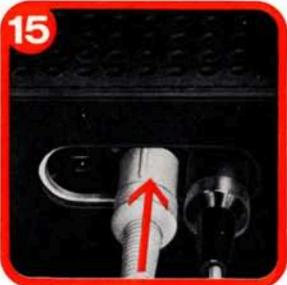
Mikrophonstecker (blau gekennzeichnet) in die blau gekennzeichnete Buchse des Recorders stecken. (Bei Verwendung des Philips Originalmikrophons nur blau gekennzeichneten Stecker anschließen.)
