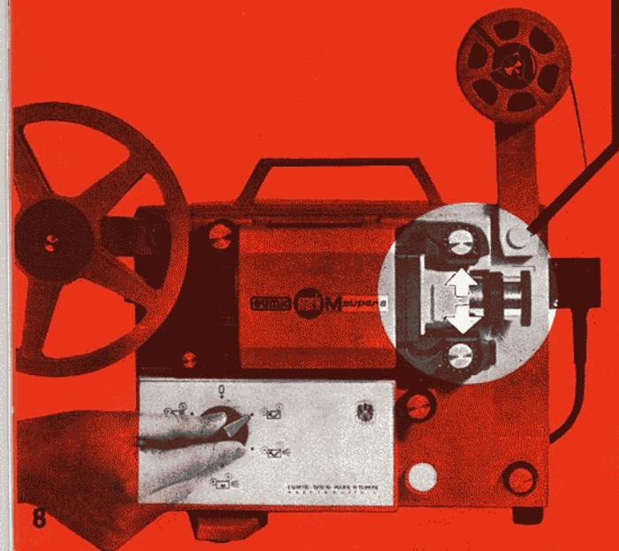
Drücken Sie zuerst die Taste für die Einlegeautomatik kräftig bis zum Anschlag nieder.
