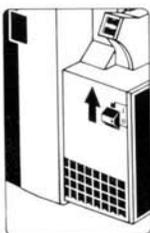
**Achtung:** Projektoren in einigen Spezialausführungen sind mit einem Netzschalter ausgerüstet. Er befindet sich links seitlich am Gehäuse und ist gegen den Zentralschalter verriegelt. Betätigung nur möglich, wenn sich der Zentralschalter in Stopstellung
