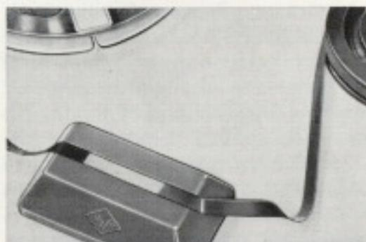
Abb. 29/30 Die richtig geschnittenen Bandenden werden in die Klebeschiene eingelegt, aneinandergestoßen und mit weißem Klebeband überklebt
