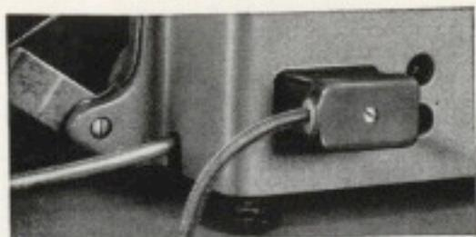
Abb. 5 Tonkoppler-Anschluß am T 10
