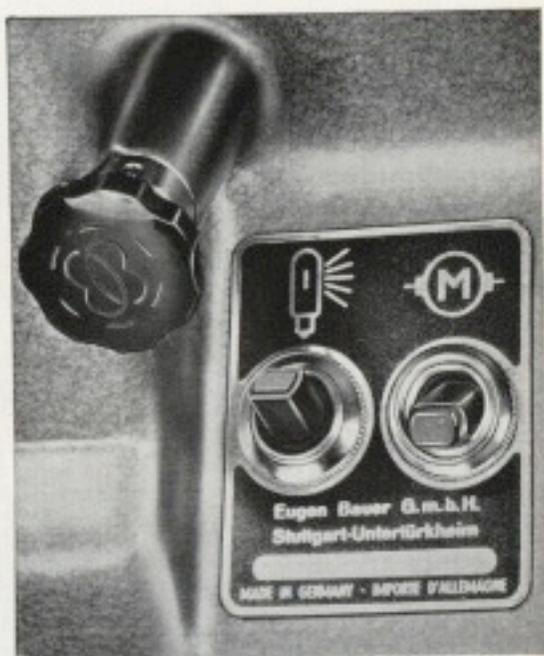
Abb. 7 Schalterplatte des Projektors. Schalterstellung für Tonfilmbetrieb: Lampe ein- und Motor ausgeschaltet
