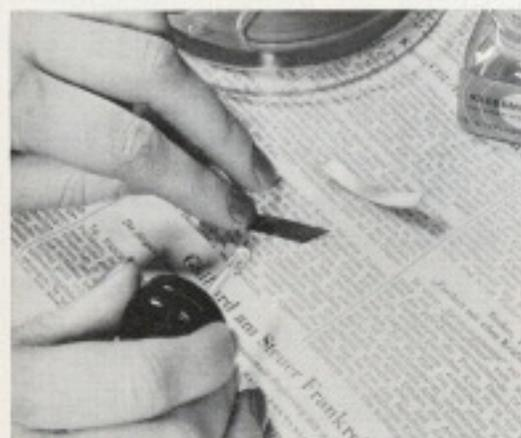
Abb. 31 Hilfsmittel zum Tonbandkleben mit flüssigem Klebemittel sind ein Stückchen Vorspannband und der flüssige Tonbandkleber (Bild oben)
