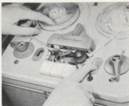
Abb. 21 Klopfstelle auf den Tonkopf verlegen; Schnellstopptaste nach Durchlauf der Klopfstelle anziehen und Tonband an Abwickelspule langsam zurückdrehen
