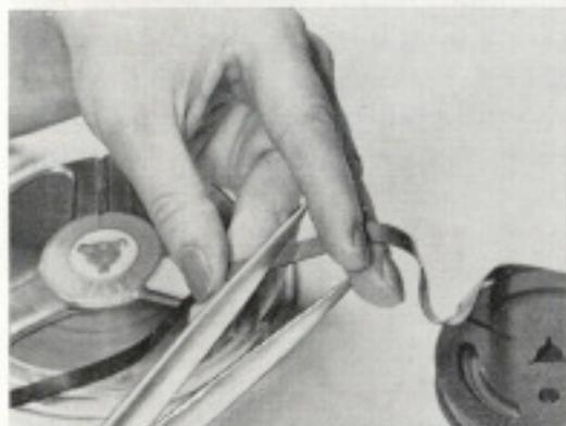
Abb. 27 So werden Tonbänder geschnitten: Aufeinanderlegen beider Tonbandenden und schräger Schnitt beider Bänder gleichzeitig
