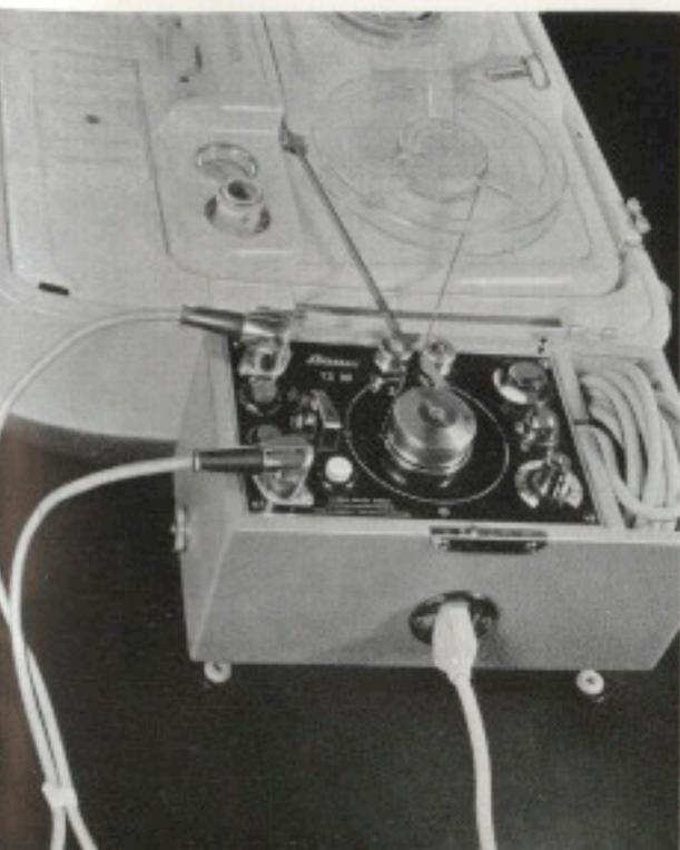
der zweiten Szene zu sehen ist. Sie schneiden das Tonband an dieser Stelle direkt auf dem Wiedergabekopf ab und kleben den Tonbeginn, also den Klappenknall der zweiten Szene, direkt an die abgeschnittene erste an. Sie lassen Ihren Film nun wieder von vorne laufen und kontrollieren, ob die Klebestelle richtig gemacht wurde. Die dritte und alle folgenden Szenen werden auf dieselbe Weise zusammengestellt.
