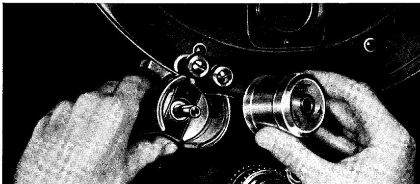
Abb. 18 Abnehmen der Kanalrolle vom Feuerschutzkanal
